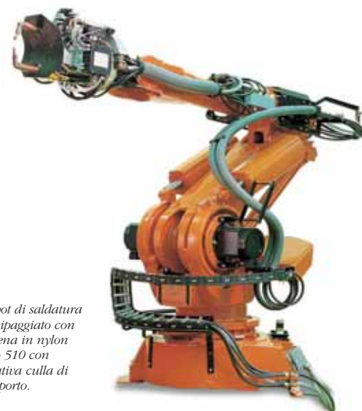
Catene rotative della serie Robot installate su linea di saldatura.
