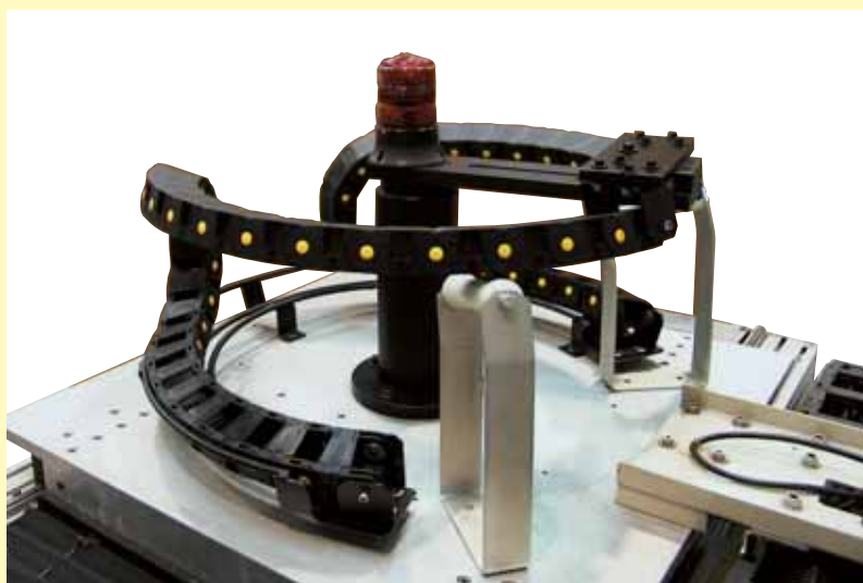
Applicazione di due catene ad anello tipo 495 con rullo di sostegno.
