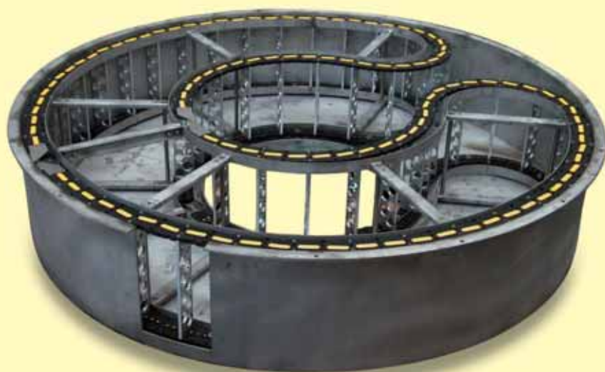
Rotazione in piano con due catene. Rotazione 370°.
