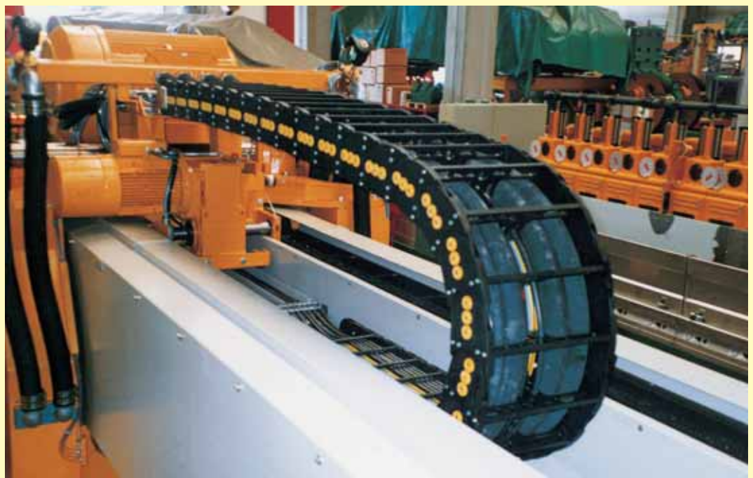
Catena in nylon tipo 310 in regime di autoportanza.
